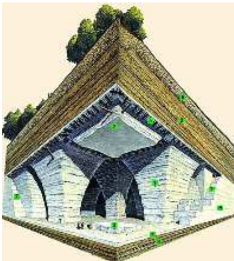
Photo 2 : Schéma d'une carrière souterraine exploitée par la méthode des piliers tournés dans le gypse ludien
